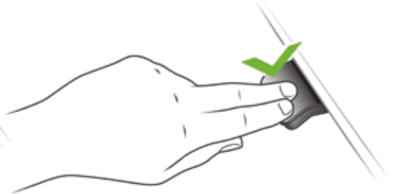
Abbildung 6: Drücken und halten Sie das DPG1K, um den Tisch nach unten zu fahren
